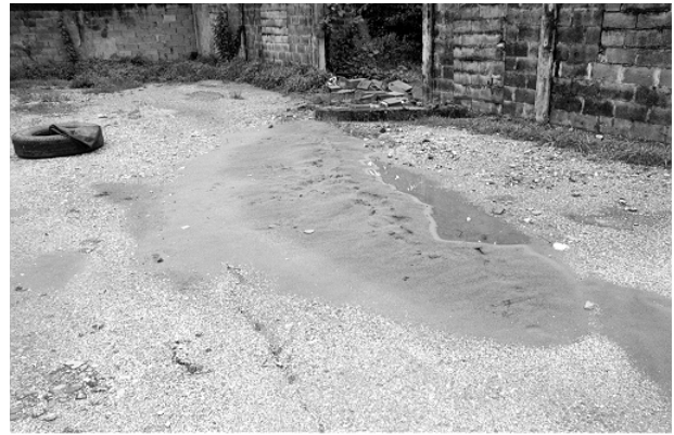
Bild 2. Bodenverflüssigungseffekte in Cariaco
