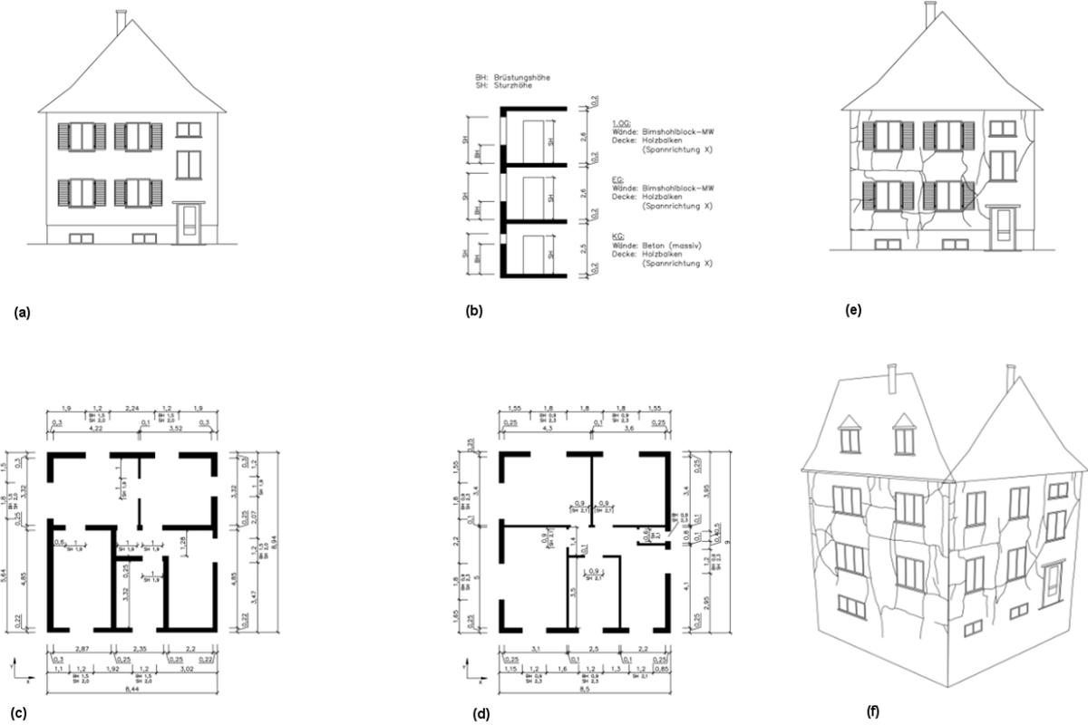
**Abb. 7:** Aufbereitetes CAD - Gebäude für die weitere analytische Bewertung: Ansicht Gebäude (a); Aufriss Gebäude (b), Grundriss KG (c), Grundrisse EG und OG (d), Schadensbild in x-Ebene (e) sowie Schadensbild in x-y-Ebene (f)
